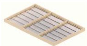
Instalación entre vigas
